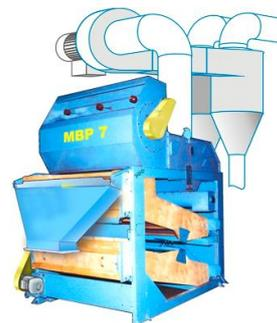
Рама; приемная камера с питающим валиком, подгруженным клапаном и барабаном-скельператором; воздушная часть с каналом первой и двумя второй аспирации с клапанами регулировки напора воздуха; осадочная камера со шнеком вывода легких и тяжелой примесей; нижний и верхний решетчатые станы с шариковой очисткой, выполненные из влагостойкой фанеры и дерева; эксцентриковый вал с шатунами; электропривод.
