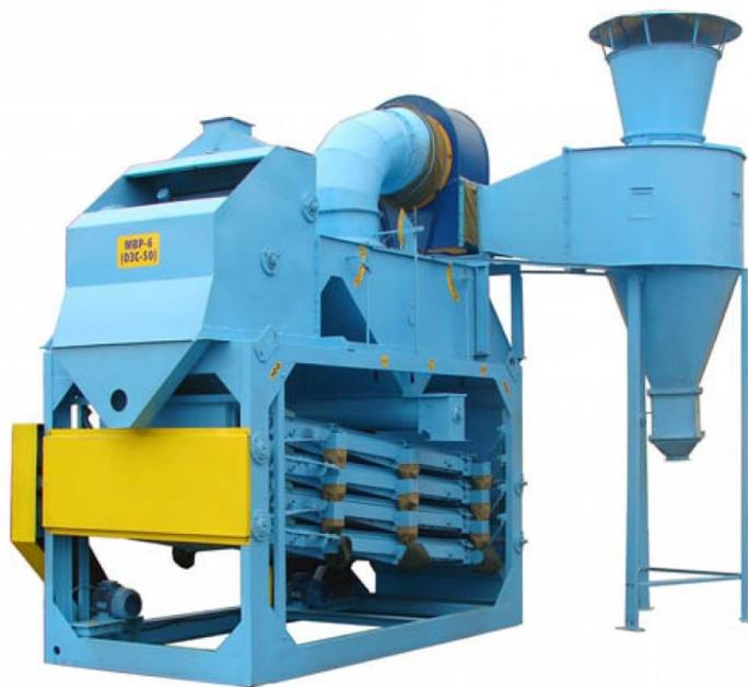
Рама; приемная камера с питающим валиком и подгруженным клапаном, сетчатым барабаном-скельператором и пневмоканалом первой аспирации; осадочная камера со шнеком отходов; пневмоканал второй аспирации; блок решетных станов, два эксцентриковых вала, механизм очистки решет; электропривод.
