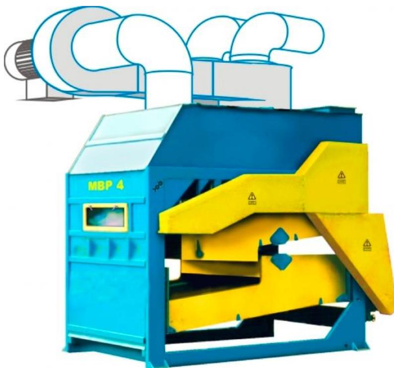
Рама, приемная камера с питающим валиком и подгруженным клапаном, воздушная часть с пневмоканалами первой и второй аспирации с клапанами грубой и тонкой регулировки напора воздуха и тремя осадочными камерами со шнеками вывода легких и тяжелых примесей, нижний и верхний решетчатые станы с шариковой очисткой, выполненные из влагостойкой фанеры и дерева, эксцентриковый вал с шатунами и электропривод.
