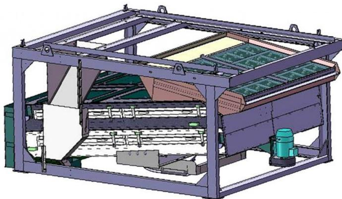
Рама; решетный стан с шариковой очисткой, с верхним ярусом решет, противоположно наклоненным к месту загрузки двух нижних, на четырех канатных подвесках; привод дебаланса, сообщающего круговые движения стану; электропривод.
