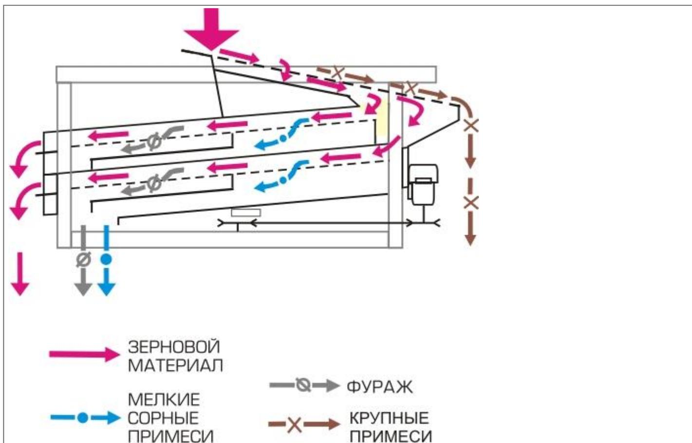
Исходный материал: ворох зерна сельскохозяйственных растений при влажности 20%, прошедших воздушную обработку на машинах МПО-50, МПО-50С, МПО-100 или на воздушных машинах других типов.
